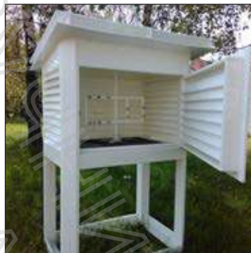
Мал. 1. Метеорологічна будка. У ній розміщують термометр та інші прилади, які потребують захисту від дощу, снігу, прямих сонячних променів, вітру.
