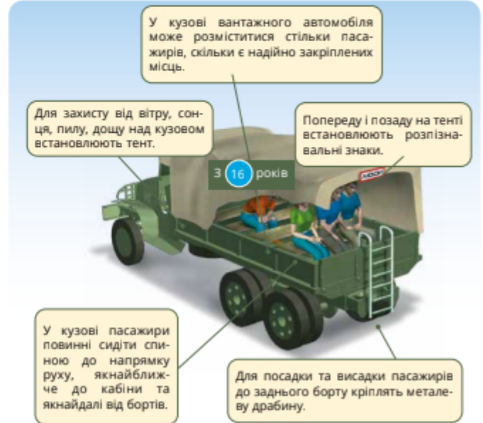
Мал. 28. Вимоги до вантажних автомобілів, що перевозять пасажирів
