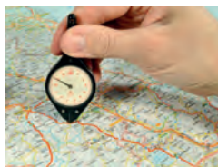
Вимірювання кривих ліній на карті за допомогою курвіметра
