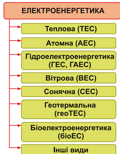
Мал. 88. Склад електроенергетики
